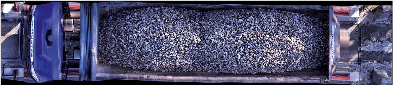
Bild 1: Ladefläche mit einer RC-Gesteinskörnung aufgezeichnet mittels VIS-Technologie bei Durchfahrt eines LKW unter einem Erfassungssystem
